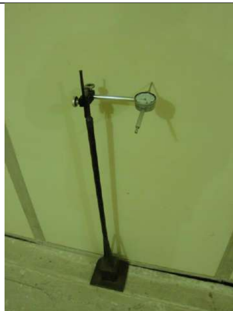
Figura 2-Medición de desplazamiento horizontal
