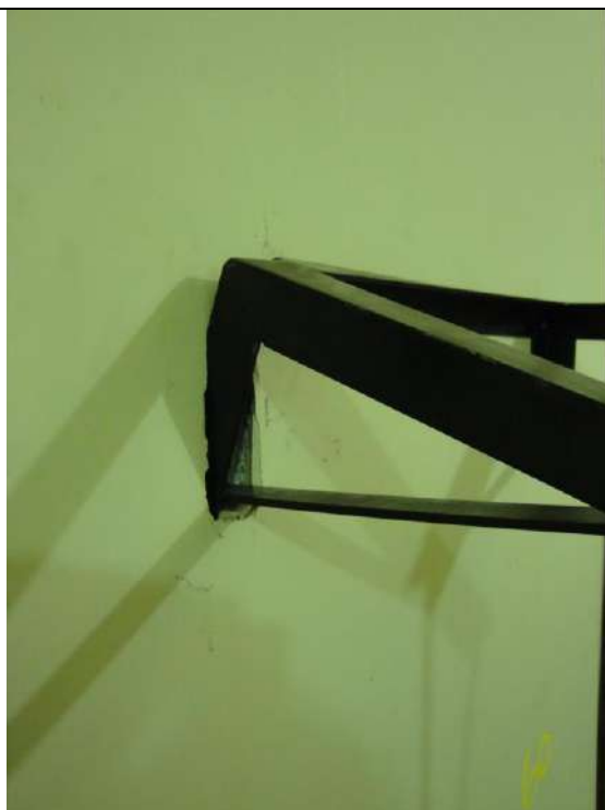
Figura 5 – Ruptura para 1,2 kN
