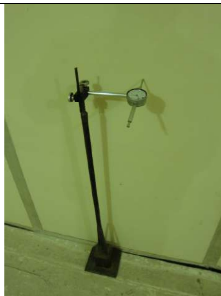
Figura 2 – Medição de deslocamento horizontal
