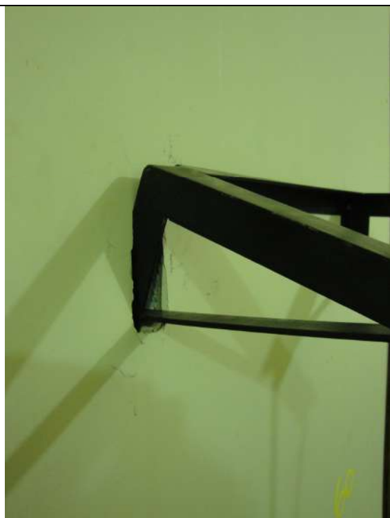
Figura 5 – Ruptura para 1,2 kN
