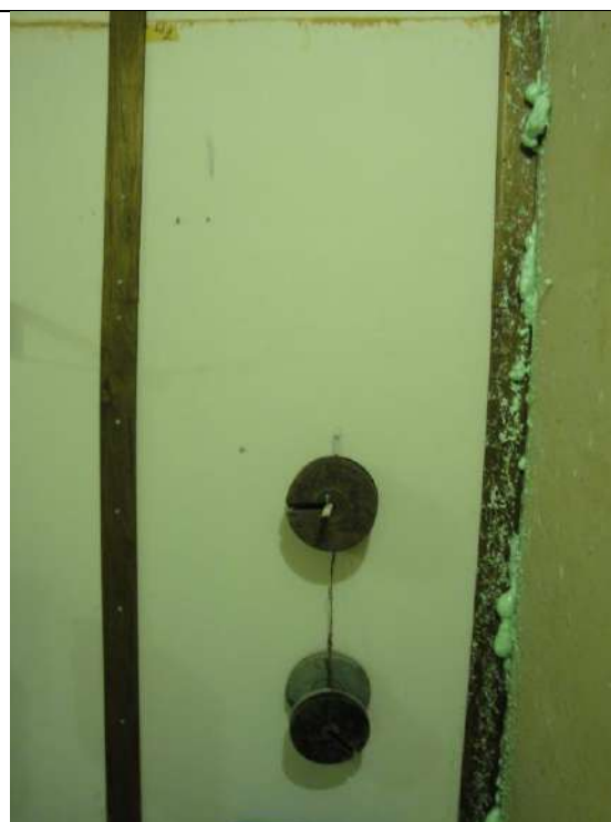
Figura 8 – Ângulo L – Buje Wurth W -GS – 0,6 kN
