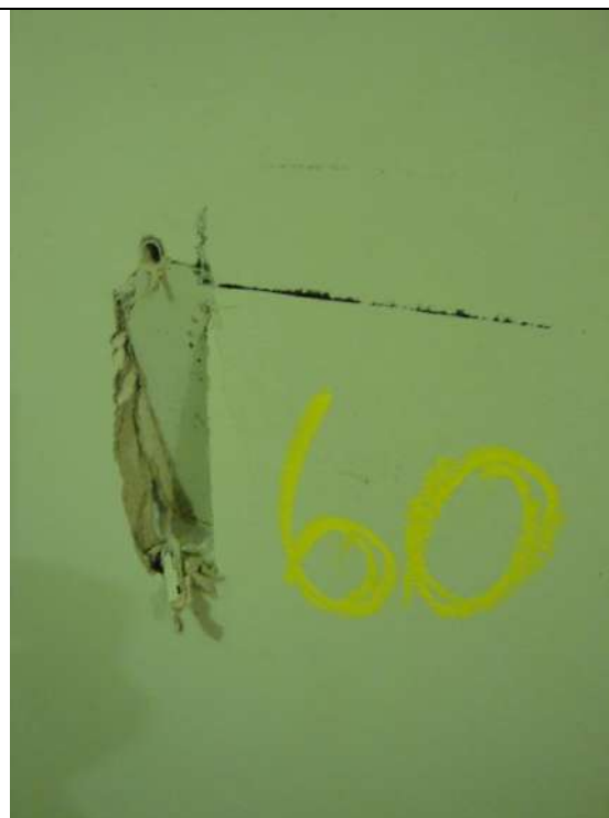
Figura 6 – Detalhe – ruptura carga 1,2 kN
