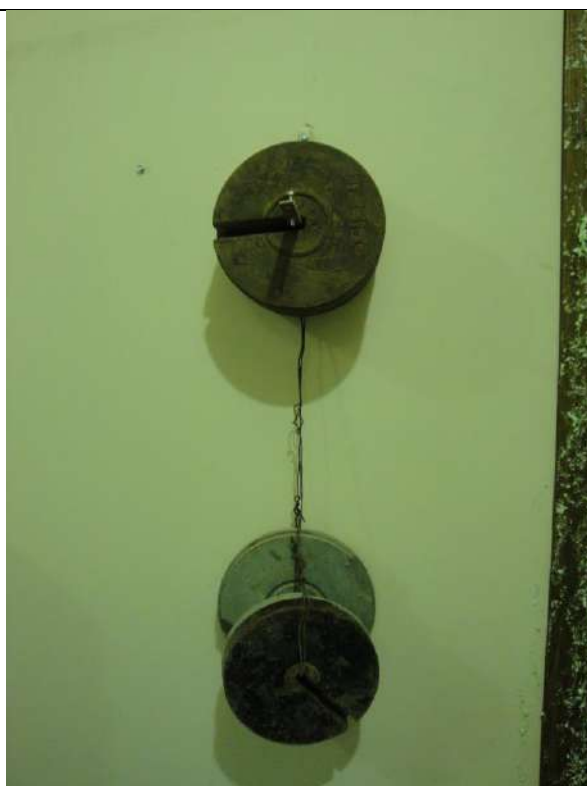
Figura 7 – Cama L – clavo – 0,6 kN
