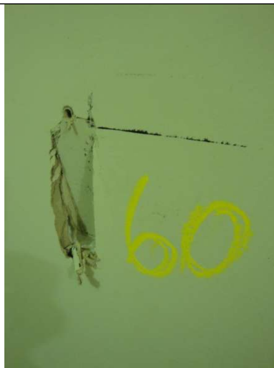
Figura 6 – Detalhe – ruptura carga 1,2 kN
